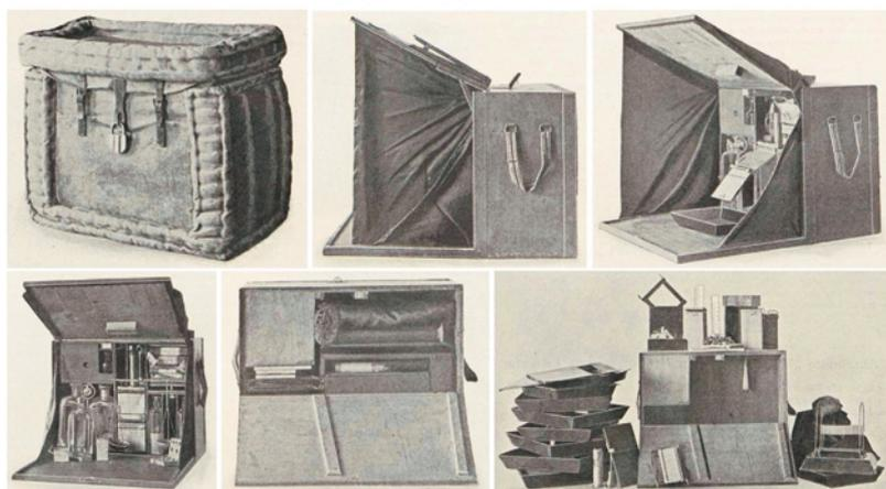
*Abb. 11: Fülleborns fotografischer Arbeitskasten: als Trägerlast verpackt; aufgeklappt; mit herabgelassenen Seitenvorhängen zum Entwickeln der Platten; eingerichtet zum Abwiegen der Chemikalien; von der Rückseite mit verstautem sowie ausgepacktem Inhalt.*<sup>332</sup>
