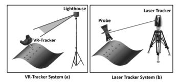
**Abb. 1:** 3D-Erfassung einer Oberfläche mittels VR-Tracker (a) und konventionellem Lasertracker (b) (Bilder der Komponenten von *vive.com* und *leica-geosystems.com*).
