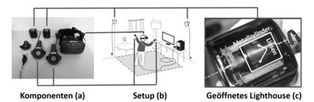
**Abb. 2:** Systemkomponenten des VR-Systems HTC Vive Pro, empfohlenes Setup (VIVE 09/2019) und geöffnetes Lighthouse (CNLOHR 2018).
