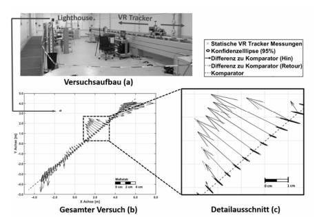
**Abb. 5:** Untersuchung der Systemgenauigkeit des VR-Trackers am Horizontalkomparator: Positionsabweichungen von Hin- und Rückweg, wobei der VR-Tracker den Sichtbereich der Lighthouses nie verlassen hat.
