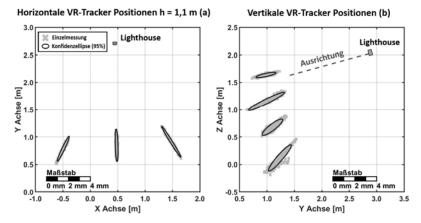
**Abb. 4:** Horizontale Scatterplots auf 3 Positionen auf selber Höhe (a), Vertikale Scatterplots auf 4 Positionen in einer Ebene mit dem Lighthouse (b).
