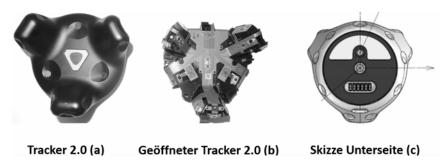
**Abb. 3:** VR-Tracker: geschlossene Ansicht (a), geöffneter Tracker (b), Skizze der Unterseite (HTC 2017).
