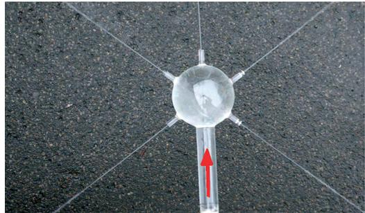
**Abb. 2.14** Druckausbreitungsversuch mit Wasser: Der Kolben erzeugt in Pfeilrichtung im Zylinder einen Überdruck, der sich in das Kugelgefäß fortpflanzt und dort in alle Richtungen gleichmäßig ausbreitet. Alle Wasserstrahlen sind gleich stark.
