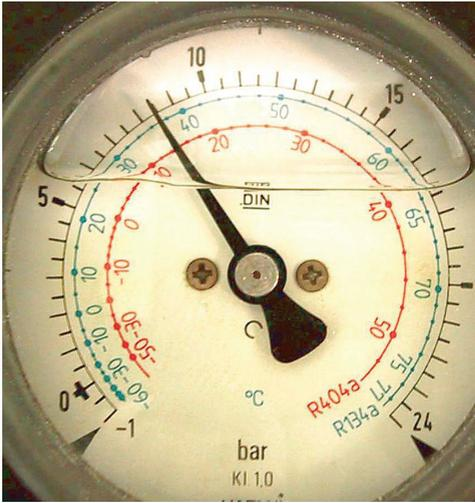
**Abb. 2.19** Manometerablesung:  $p_e = 8,5$  bar, Barometerstand  $p_a = 1$  bar, absoluter Druck  $p_{abs} = 1 \text{ bar} + 8,5 \text{ bar} = 9,5 \text{ bar}$ . Die Genauigkeitsklasse beträgt 1,0 (KI. 1,0). Das bedeutet, dass die Messungenauigkeit des Manometers 1 % vom Endausschlag (hier 24 bar) beträgt, also 0,24 bar. Der angezeigte Druck liegt also im Bereich  $8,5 \pm 0,24$  bar, also zwischen 8,26 und 8,74 bar.
