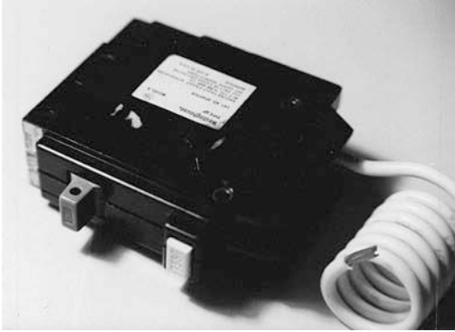
Bild 4.9 Amerikanischer zweipoliger Leitungsschutzschalter (Ground Fault Circuit Interrupter GFCI) mit durchgeführtem Neutralleiter (PEN-Leiter), Nennspannung 2 \times 120 V, Nennfehlerstrom 5 mA für den Zusatzschutz bei Nullung im TN-System mit netzspannungsabhängiger Verstärkerschaltung zur Fehlerstrom-Erfassung. Die rechts gezeigte Spirale ist der Anschluß-Drahtwendel für den PEN-Leiter.
