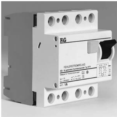
Bild 4.5 Fehlerstromrelais mit getrenntem Durchsteckwandler, Nennfehlerstrom 0,3 A und 1 A; Öffnungsdurchmesser der Durchsteckwandler 60 mm und 130 mm
