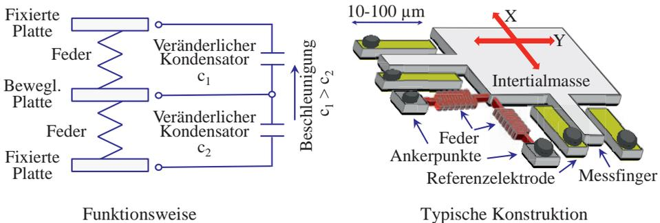
**Abbildung 2.7:** MEMS-Beschleunigungssensoren
