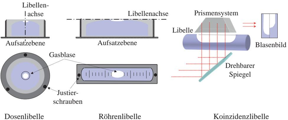
**Abbildung 2.2:** Aufbau der geodätischen Libellen
