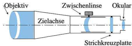
**Abbildung 2.1:** Aufbau des Messfernrohrs
