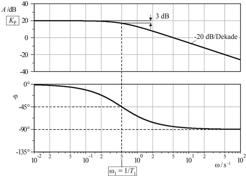
**Bild 8.8** Bode-Diagramm eines P-T<sub>1</sub>-Glieds mit  $K_p = 10$  und  $T = 2$  s
