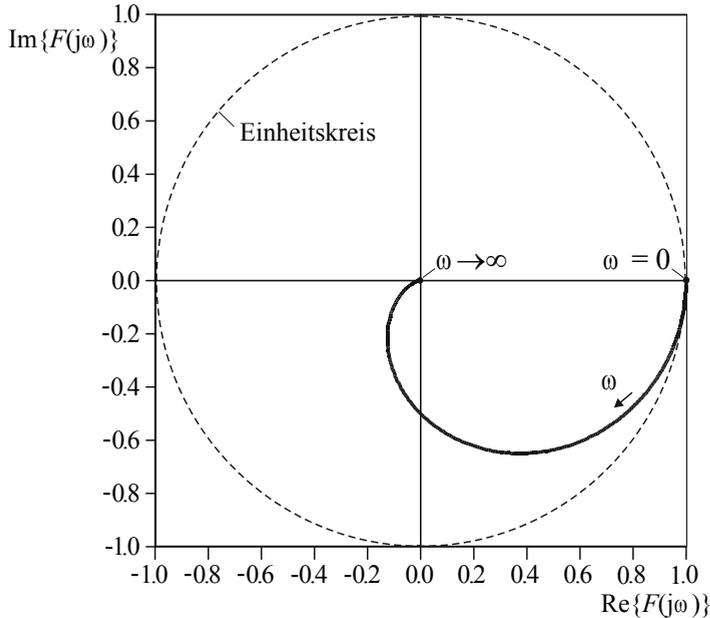
**Bild 8.4** Nyquist-Ortskurve des P-T<sub>2</sub>-Glieds mit dem Bode-Diagramm gemäß Bild 8.3
