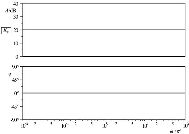
**Bild 8.6** Bode-Diagramm eines P-Glieds mit  $K_P = 10$
