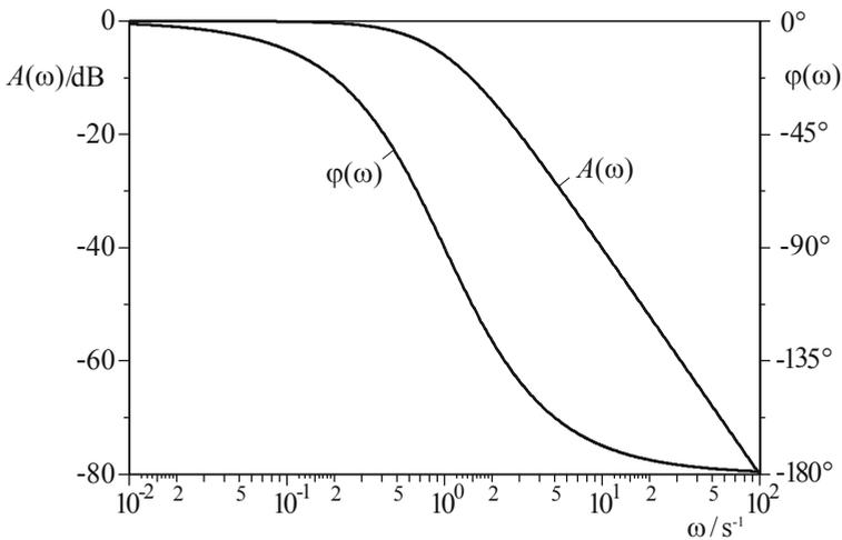
**Bild 8.3** Bode-Diagramm eines P-T<sub>2</sub>-Glieds, bestehend aus Betrags- und Phasenkennlinie
