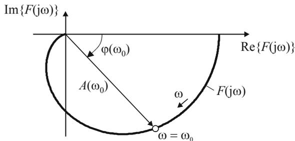
**Bild 8.5** Zusammenhang zwischen Betrag/Phase und Real-/Imaginärteil des Frequenzgangs  $F(j\omega)$
