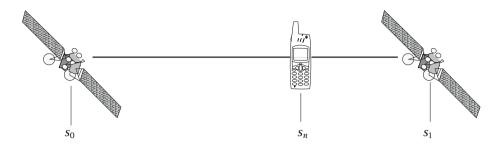
**Bild 2.7** Eindimensionale Positionsbestimmung
