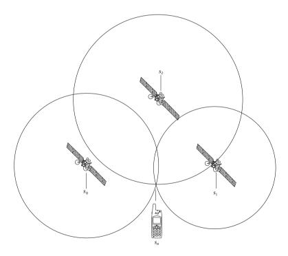
**Bild 2.8** Zweidimensionale Positionsbestimmung
