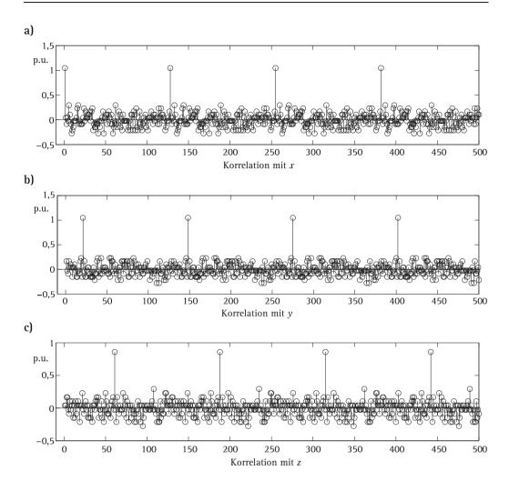
Bild 2.6 Korrelation der Summensequenz mit den einzelnen Sequenzen
