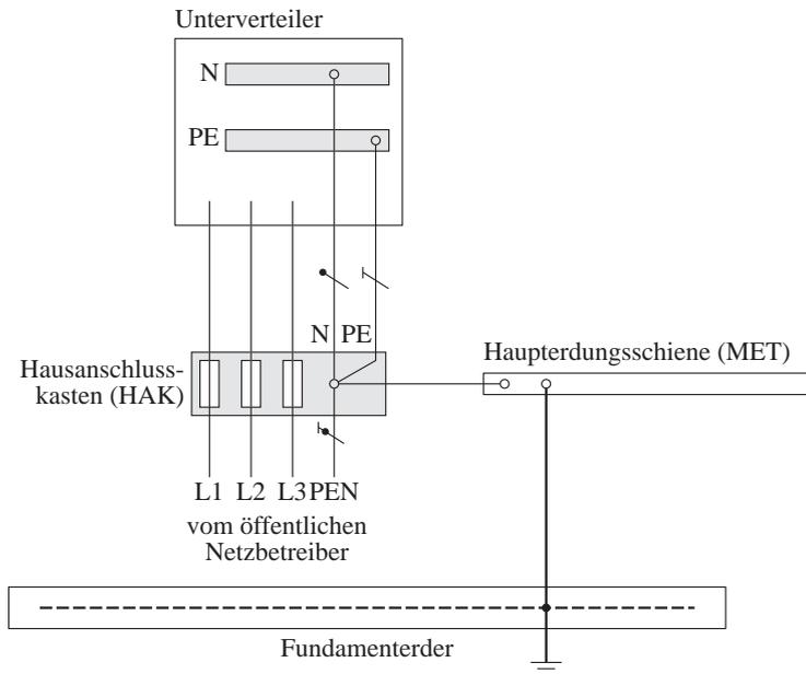
**Bild 6.3** Ort der Änderung eines TN-C-Systems in ein TN-S-System
