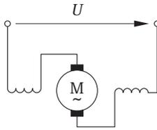
Bild 2.12 Schematischer Aufbau eines Reihenschlussmotors mit zwei getrennten Erregerwicklungen
