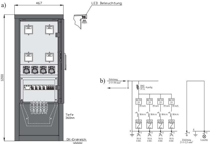
**Bild 9.3** Zeichnung und Prinzipschaltbild eines Stromverteilers für Campingplätze –
