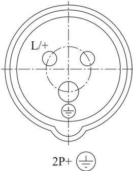
**Bild 9.4** Anschlussbelegung von dreipoligen Industriesteckdosen
