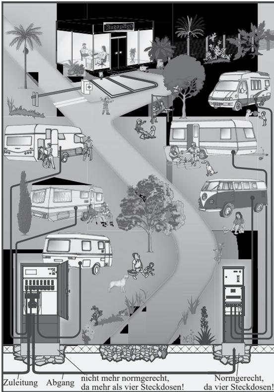
**Bild 9.1** Schemadarstellung – Versorgung der Stellplätze mit jeweils einer Steckdose; max. vier pro Verteiler
