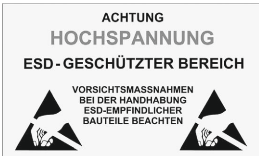
Bild 10.3 Kennzeichnungsschild für eine EPA mit frei liegenden Leitern
