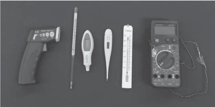
Abb. 5: diverse Thermometer (ganz links: Infrarotthermometer; ganz rechts: Thermoelement)
