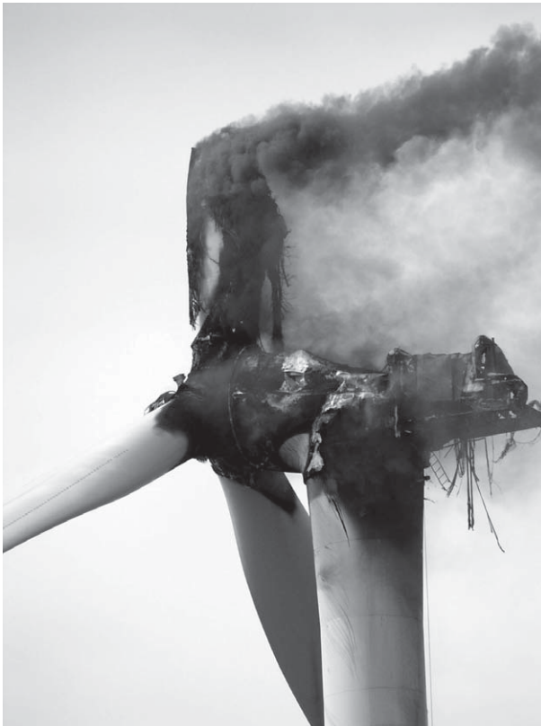
Bild 2.8 Blitzschlag in eine Windenergieanlage
